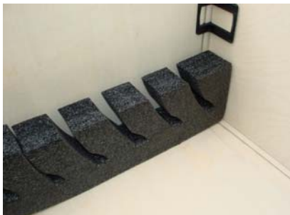
Prototyp direkt från AutoCAD till skärmaskin
